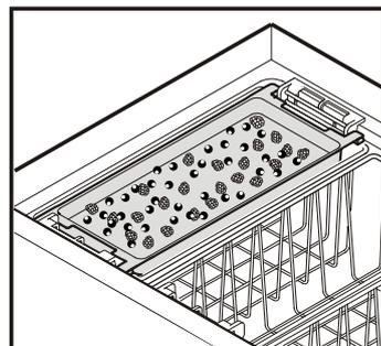
Podnos ke zmražení se dá vložit do koše, nebo vsunout jako dělicí stěna do vnitřních jímek.
