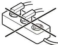
Nepoužívejte společné měniče proudu (mění stejnosměrný proud na střídavý / třífázový proud) ani úsporné zástrčky. Nebezpečí poškození pro elektroniku!
