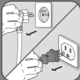
افصل الجهاز عن التيار الكهربائي
