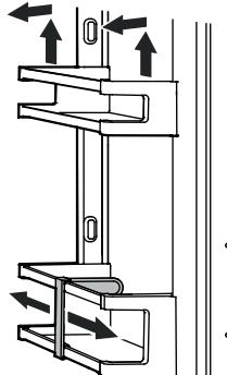
Místo pro vysoké nádoby vytvoří **poloviční skleněné desky**. Přiložené podkládací kolejnice, zob. 1, nasunout v požadované výšce vpravo a vlevo na opěrné knoflíky.
