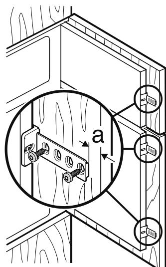
S dolními závitovými pouzdry nastavte výšku spotřebiče vzadu.
