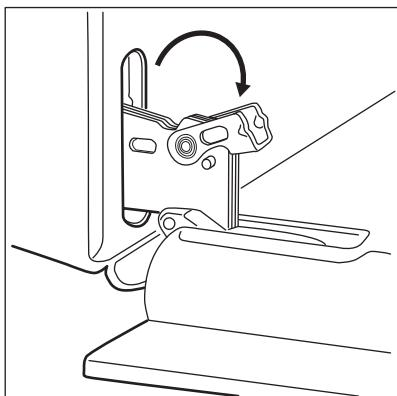
6. Přivřete dvířka trouby do první polohy otevření (do poloviny). Pak dvířka vytáhněte směrem dopředu z jejich umístění.
