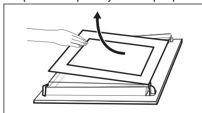
11. Sklenené panely umyte vo vode so saponátom. Sklenené panely opatne osušte.
