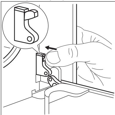
3. Jednou rukou držte zatlačený prvek. Pomocí šroubováku druhou rukou nadzdvihněte a otočte páčku pravého závěsu dvírek.
